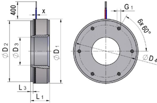
**Typ 621** (flanschseitig montiert)
