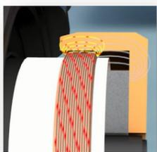
Im Gegensatz zum Lautsprecher, bei dem der Magnet starr an einem Korb befestigt ist, wird dieser beim IPG axial beweglich in einer weichen Aufhängung aus Metallfedern gelagert. Dadurch werden einerseits eine niedrige Resonanzfrequenz des Magneten und eine besonders gute Performance gerade bei niedrigen Frequenzen erreicht. Andererseits gelingt so sowohl eine hohe Robustheit, als auch eine hohe Schutzklasse.
