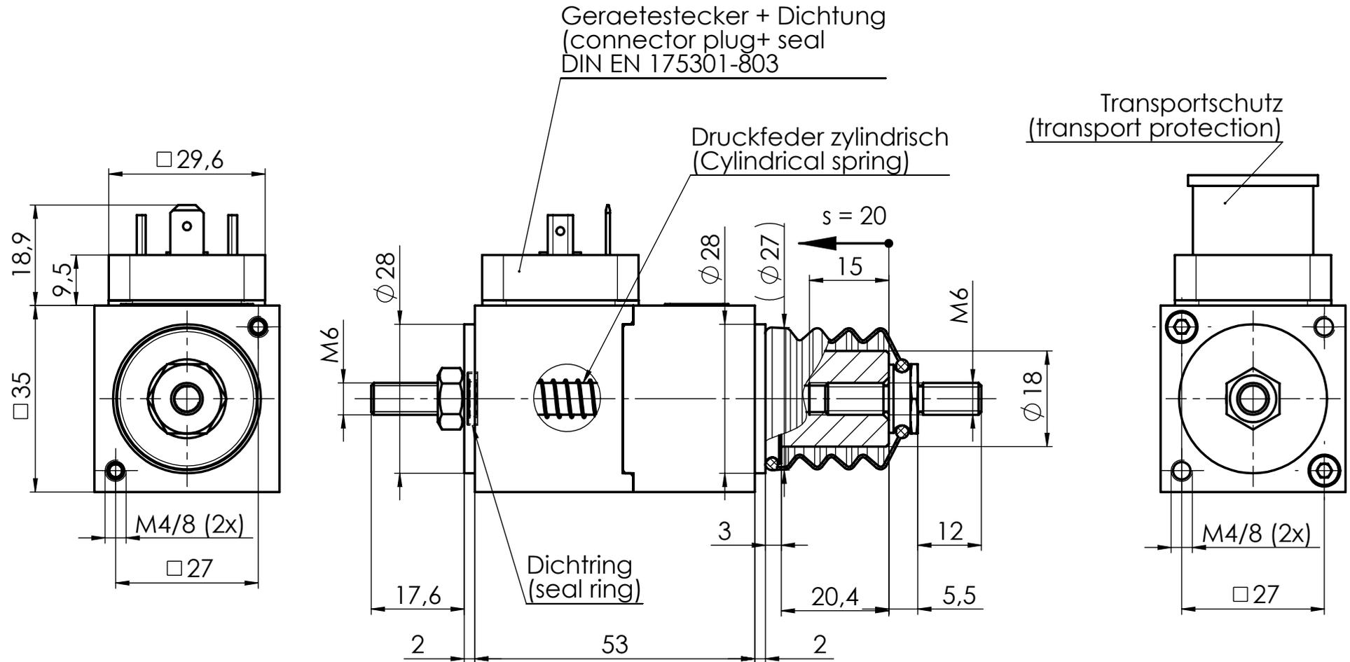
ⓑ \*100% ED ist nur gegeben bei montagebedingter Wärmeableitung über Anbauteile bspw. aus Stahl oder Alu mit einer äquivalenten Fläche von mindestens 300cm<sup>2</sup> und einer Materialstärke von 10mm
