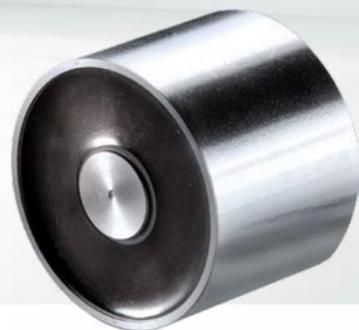
Queste elettrocalamite con magnete permanente sono solenoidi di ritenuta elettricamente commutabili. Costituiti da un magnete permanente e da una bobina in corrente continua che serve per neutralizzare il campo magnetico permanente sulla superficie di tenuta. Il componente è trattenuto grazie alle linee aperte del circuito magnetico.
